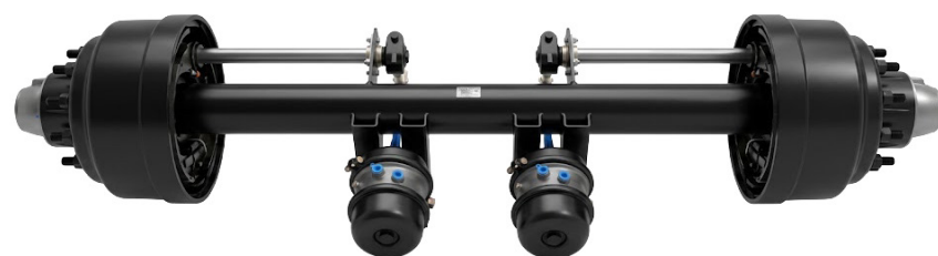
EJE PATRÓN AMERICANO METAGRO PARTS CON FRENO ACEITE - 10 BIRLOS / PUNTA CÓNICA / 15 TON. / TRACK 77.5"
